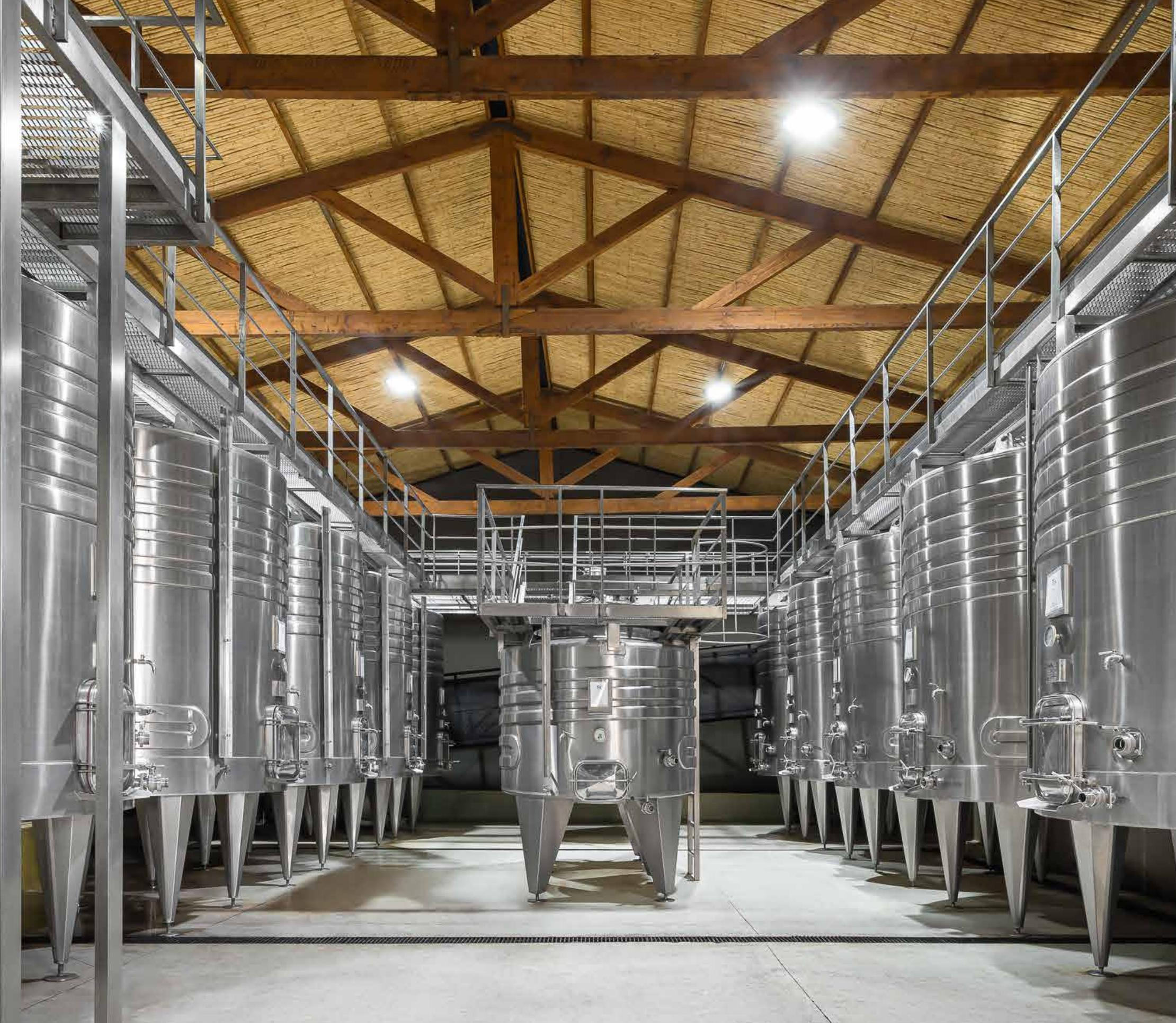
Sala de tanques de acero inoxidable de 10.000 y 3.000 lts de capacidad.
